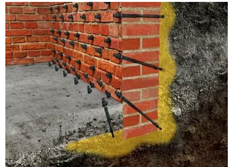
Схема инъектирования контурного пространства
